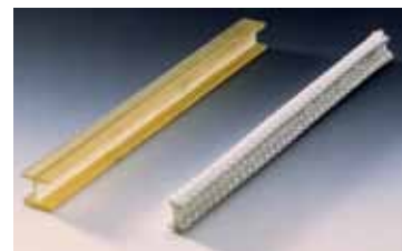
▲ 図4 I型断面組紐と繊維強化複合材料の開発例
