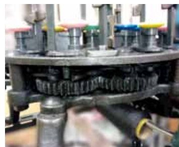
▲ 図5(b) 丸打組機 ホーンギアによるスピンドル移動機構
