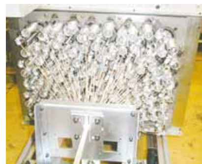
図 11 ホーンギア方式 3 次元組機 (中実 6x8 角組系組物の場合)
