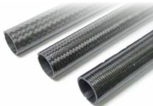
図8 組物の構造および組角度の異なる組物複合材料パイプ
